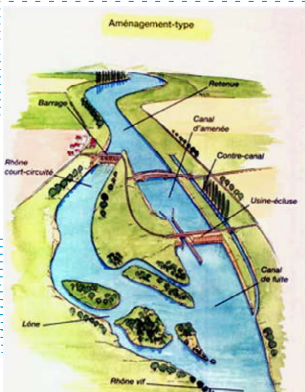
Aménagement C.N.R. type : barrage en amont de l'usine-écluse
