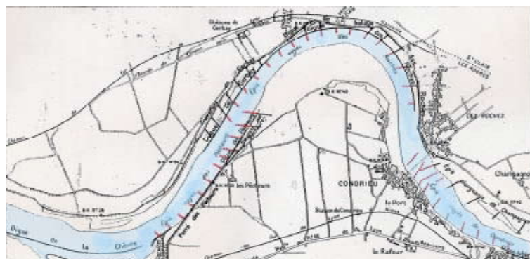
Schéma des épis Girardon (en rouge). Condrieu - Rhône
